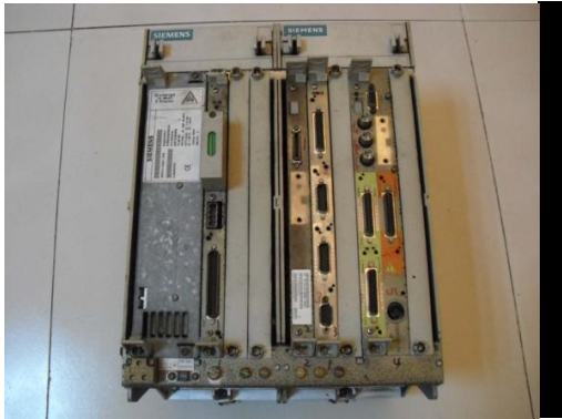
SIEMENS 840C 系统维修
